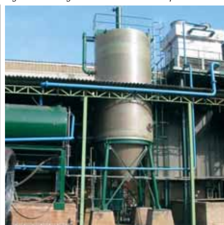
Decantatore Lamellare con telaio zincato per acque da galvanica, capacità 26 m 3 . Laminar decanter with galvanized structure used for galvanic waters, capacity 26 m 3 . Lamellarer Dekanter mit verzinktem Rahmen, angewandt für galvanisches Wasser - Kapazität 26 m 3 .
